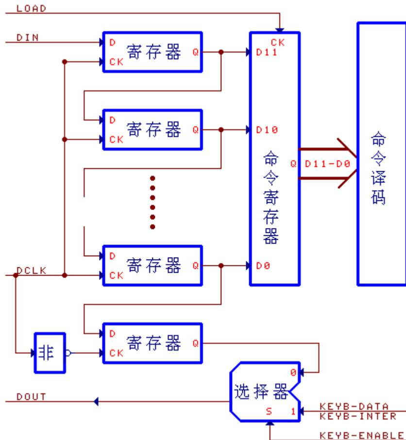
CH452 具有硬件实现的高速 4 线串行接口,包括 4 个信号线:串行数据输入线 DIN、串行数据时钟线 DCLK、串行数据加载线 LOAD、串行数据输出线 DOUT。其中,DIN、DCLK、LOAD 是带上拉的输入信号线,默认是高电平;DOUT 在未启用键盘扫描功能时作为串行数据输出线,在启用键盘扫描功能后作为键盘中断和数据输出线,默认是高电平。
