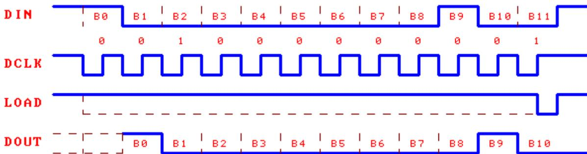
上图是在未启用键盘扫描功能时，单片机通过 4 线串行接口向 CH452 发送 12 位数据的波形示意图，数据是 00100000001B，LOAD 的低电平脉冲可以更宽，图中以虚线表示。
