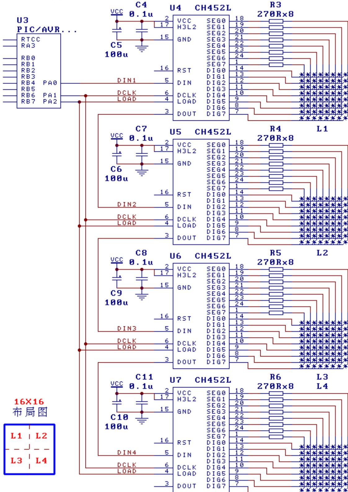
图中以 4 线接口串行级联方式驱动发光二极管 LED 点阵，单片机 U3 通过 DIN1、DCLK 和 LOAD 三根信号线控制所有的 CH452。参考 16×16 布局图，4 个 8×8 发光管阵列 L1~L4 组成 16×16 的点阵模块，如果要显示一个汉字，只要将 32 字节的点阵数据通过 8 次 48 位的加载字数据命令送给 CH452 就可以了。因为是 4 个 CH452 级联，所以每个操作命令都必须是 48 位数据，依次是 U7、U6、U5 和 U4 的命令数据，最后由 LOAD 信号线输出上升沿通知所有的 CH452 加载各自的命令数据。串联方式下，CH452 级联数量没有限制，并且只占用 3 个 I/O 引脚，其中 DIN 和 DCLK 还可以与其它接口电路共用，缺点是只有最后一级的 CH452 可以启用键盘功能，并且需要逐个开启，操作过程比并联方式复杂。
