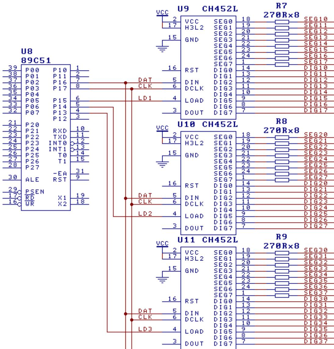
图中以 4 线接口并行级联方式驱动 24 只数码管，U8（MCS51 系列单片机）向所有的 CH452 提供一组共用的 DIN 和 DCLK 信号，并且向各个 CH452 分别提供一根 LOAD 信号线。需要对 U9 进行操作时，单片机可以通过 DIN 和 DCLK 输出串行数据，然后通过 LD1 向 U9 输出加载信号使其执行操作，而 U10 和 U11 没有收到 LOAD 信号，所以不操作。并联方式下，每一个 CH452 都可以启用键盘功能，并且操作过程比串联方式简单。
