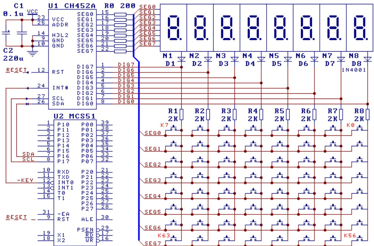
图中，单片机 U2 通过 CH452 驱动 8 个共阴数码管显示，并同时扫描 64 个按键。由于某些数码管在较高工作电压时存在反向漏电现象，容易被 CH452 误认为是某个按键一直按下，所以建议使用二级管 D1-D8 防止数码管反向漏电，并提高键盘扫描时 SEG0~SEG7 输入信号的电平，确保键盘扫描更可靠。当电源电压较低时（例如 VCC=3.3V），这些二级管应该去掉以避免影响显示亮度。
