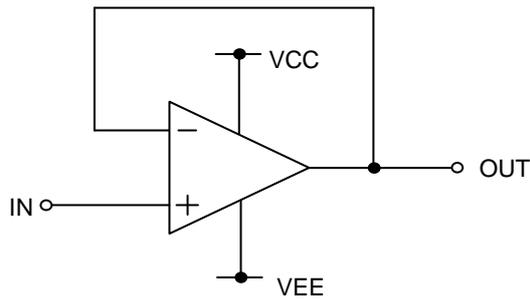
入力電圧をそのまま出力します。オペアンプの高入力抵抗、低出力抵抗のため安定した出力電圧を確保できます。
