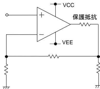
Figure 34. 出力短絡保護抵抗挿入例
