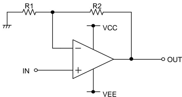
非反転増幅回路は入力電圧を R1 と R2 で決まる電圧利得で増幅した電圧を出力します。
