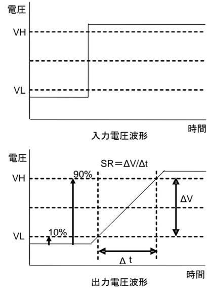
Figure 26. スルーレート測定時 入出力電圧波形例
