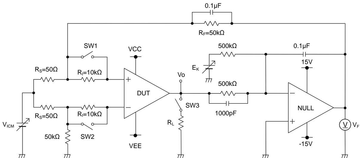
Figure 24. 測定回路例 1 (1 チャンネルのみ)
