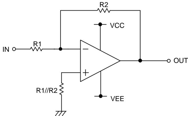
反転増幅回路は入力電圧を R1 と R2 で決まる電圧利得で増幅し、位相反転した電圧を出力します。
