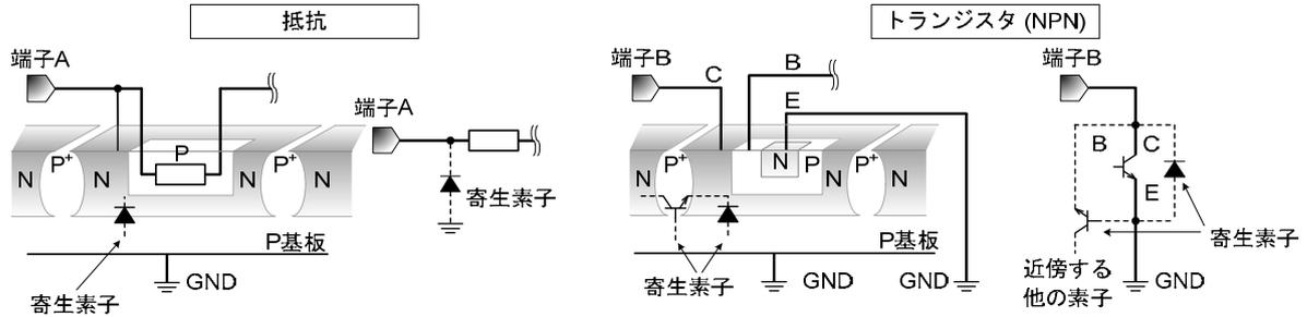
Figure 32. モノリシック IC 構造例
