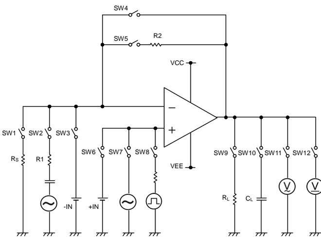
Figure 25. 測定回路例 2 (片チャンネルのみ)
