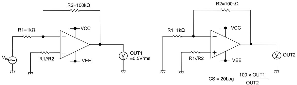
Figure 27. 測定回路例 3 (チャンネルセパレーション)
