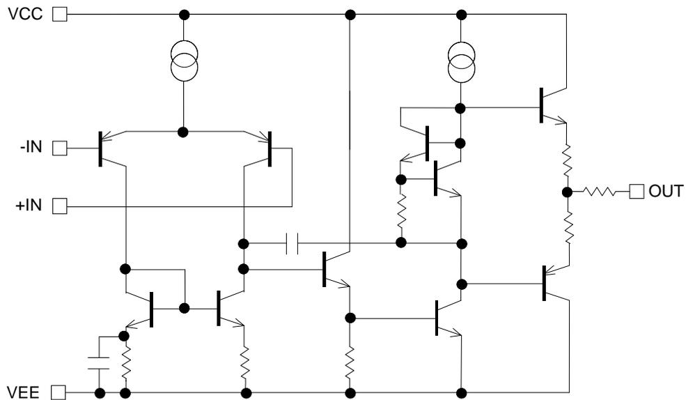
Figure 1. 内部等価回路図(1チャンネルのみ)
