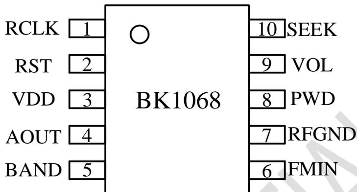
图 1 MSOP10 和 SSOP10 管脚定义俯视图
