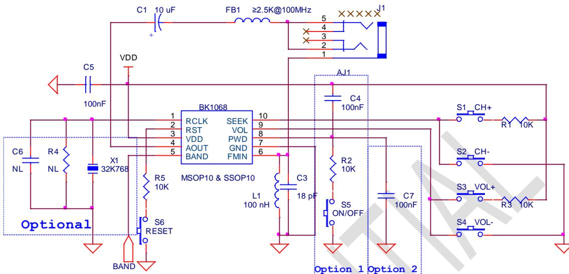
图 2 BK1068 MSOP10 和 SSOP10 应用电路
