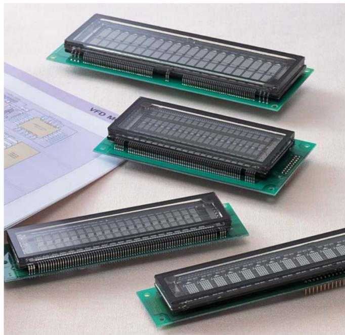
VFDモジュールは蛍光表示管、コントローラ、アノード&グリッドドライバ、電源回路などにより構成されたマンマシンインタフェースユニットです。
