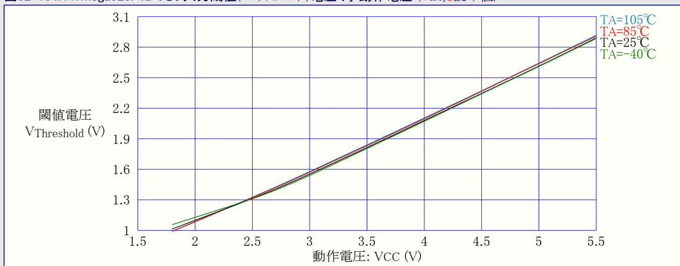
図32-164. ATmega328P:I/Oピン入力閾値(スレッショルド)電圧 対 動作電圧 ( V_{IH} , 1読み値)
